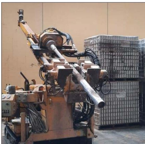
Il carotiere semplice con estrusore meccanico è particolarmente indicato per carotaggi ambientali in quanto consente di prelevare un campione il più possibile inalterato attraverso un sistema di estrusione meccanica a secco che utilizza la spinta sulla testa di rotazione della sonda.
