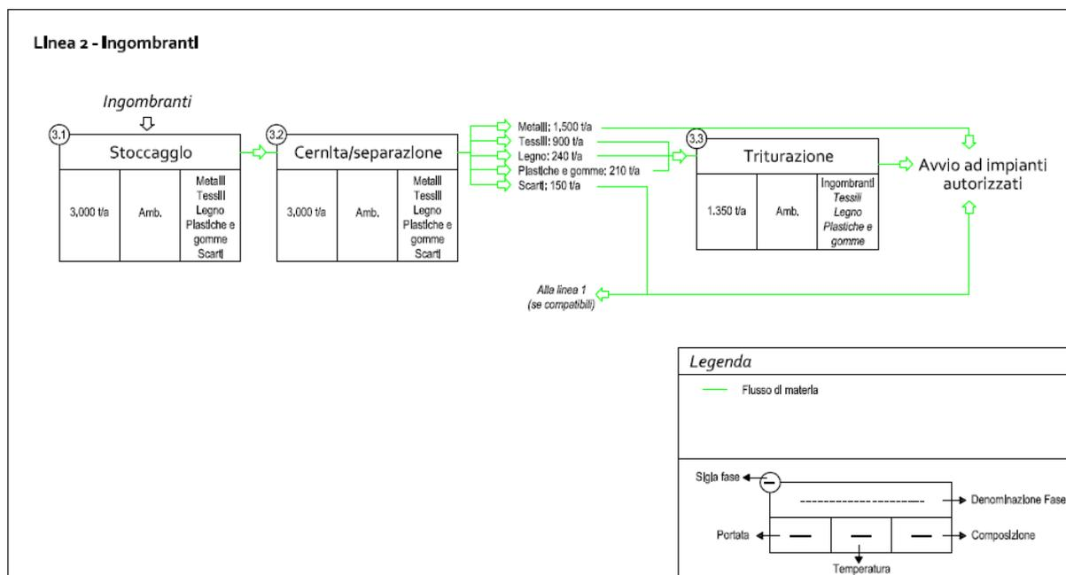
Figura 11 - Schema di flusso quantificato Linea 2
