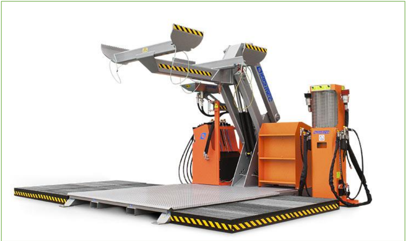
Isola di bonifica pneumatica composta da ISE isola prelievo liquidi formata da 5 pompe a membrana pneumatiche, da PFT formato da 2 pompe a membrana e trapani pneumatici e da PM-30 ponte mobile di sollevamento, comprensivo di BRL braccio raccolta oli.
