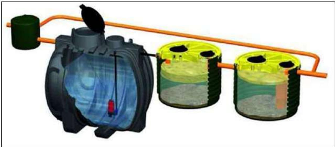
**Fig. 02** Schema tipo di impianto I pioggia
