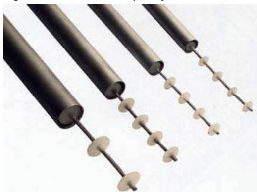
Figura – Alcuni esempi di funi e tubazioni di trasporto per alimento secco
