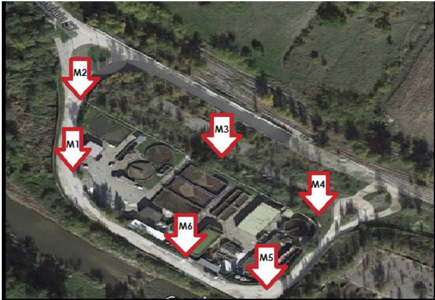
ALL.1 - Individuazione punti di verifica emissioni acustiche.
