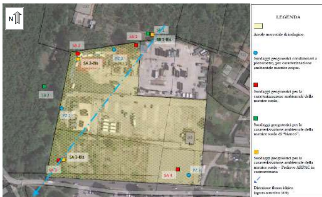
Fig. 3.9 – Stralcio planimetria fornita dal comune con ubicazione indagini eseguite ed indicazione della direzione di falda (indagini di agosto 2020)
