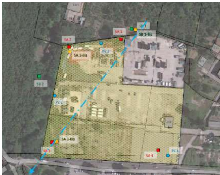
Fig. 3.12 - Ubicazione indagini con indicazione della direzione di falda (stralcio planimetria fornita dal Comune e relativa a studi pregressi)
