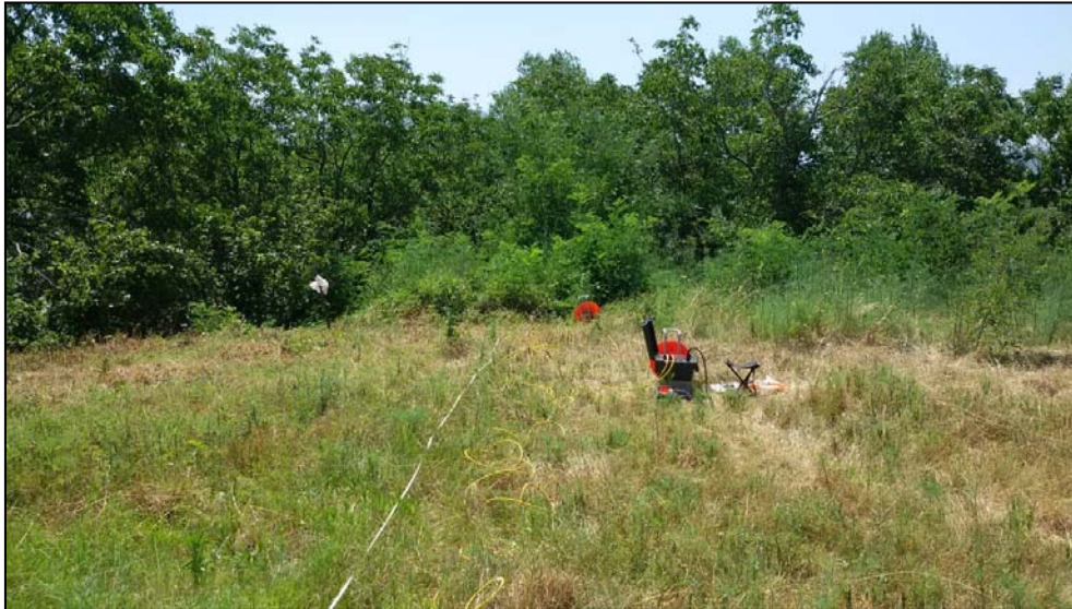
Fig. 1 – Stendimento multielettrodo n.1 effettuato presso la discarica in loc. Tuoro, nel territorio comunale di Sirignano (AV). Tomografia geoelettrica A-B. 32 elettrodi di misura, spaziatura elettrodoica 1.0m. Lunghezza complessiva stendimento 31.0m.
