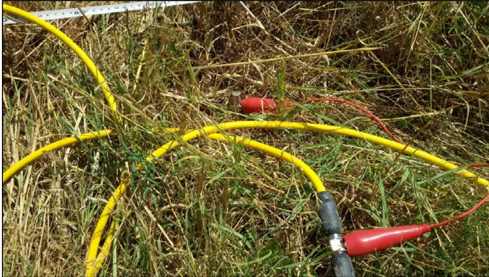
Fig. 5 – Elettrodo costituito da picchetto in acciaio inox infisso nel terreno utilizzato per le indagini geoelettriche multielettrodo effettuate.
