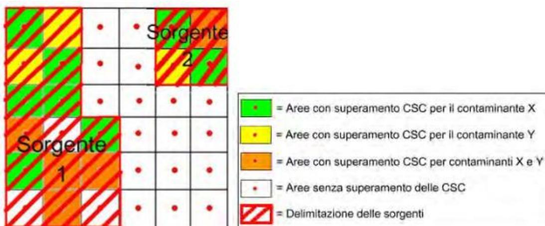
Figura: schema di campionamento sistematico a maglia regolare
