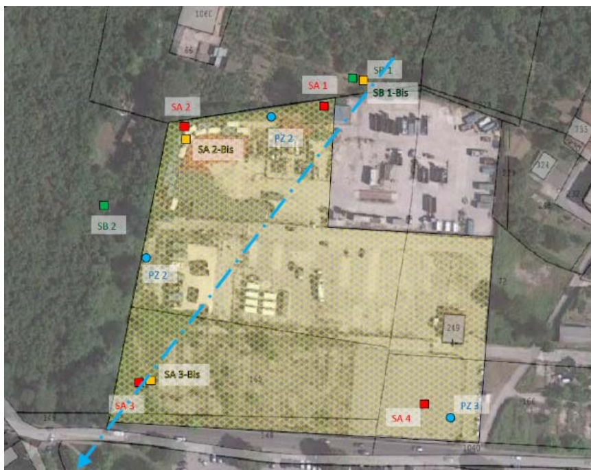
Fig. 6.12 - Ubicazione indagini con indicazione della direzione di falda (stralcio planimetria fornita dal Comune e relativa a studi progressi)
