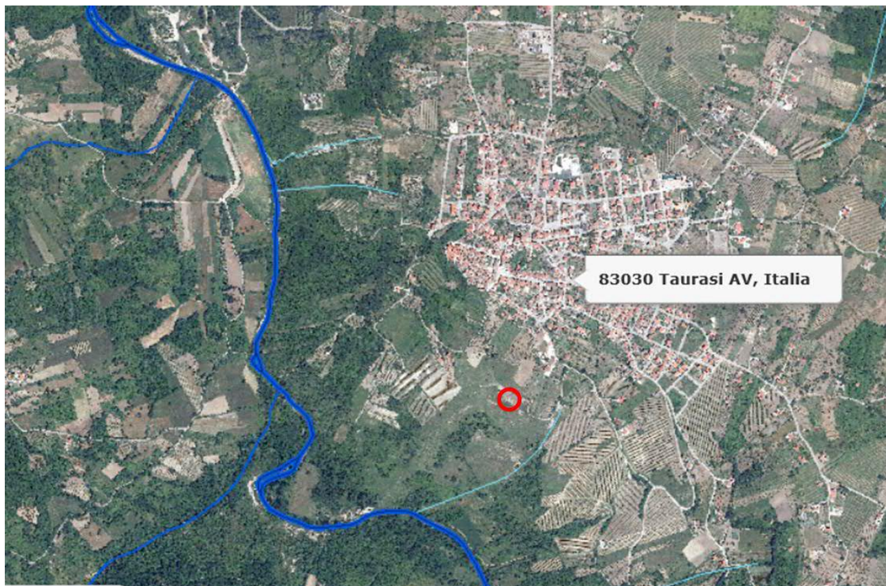
Figura 8: Retico idrografico prossimo al Sito (in rosso). Oltre al reticolo idrografico principale, è riportato il reticolo acque pubbliche (sempre in colore blu) e il reticolo idrografico indicato nella CTR alla scala 1:5000 (in colore azzurro).
