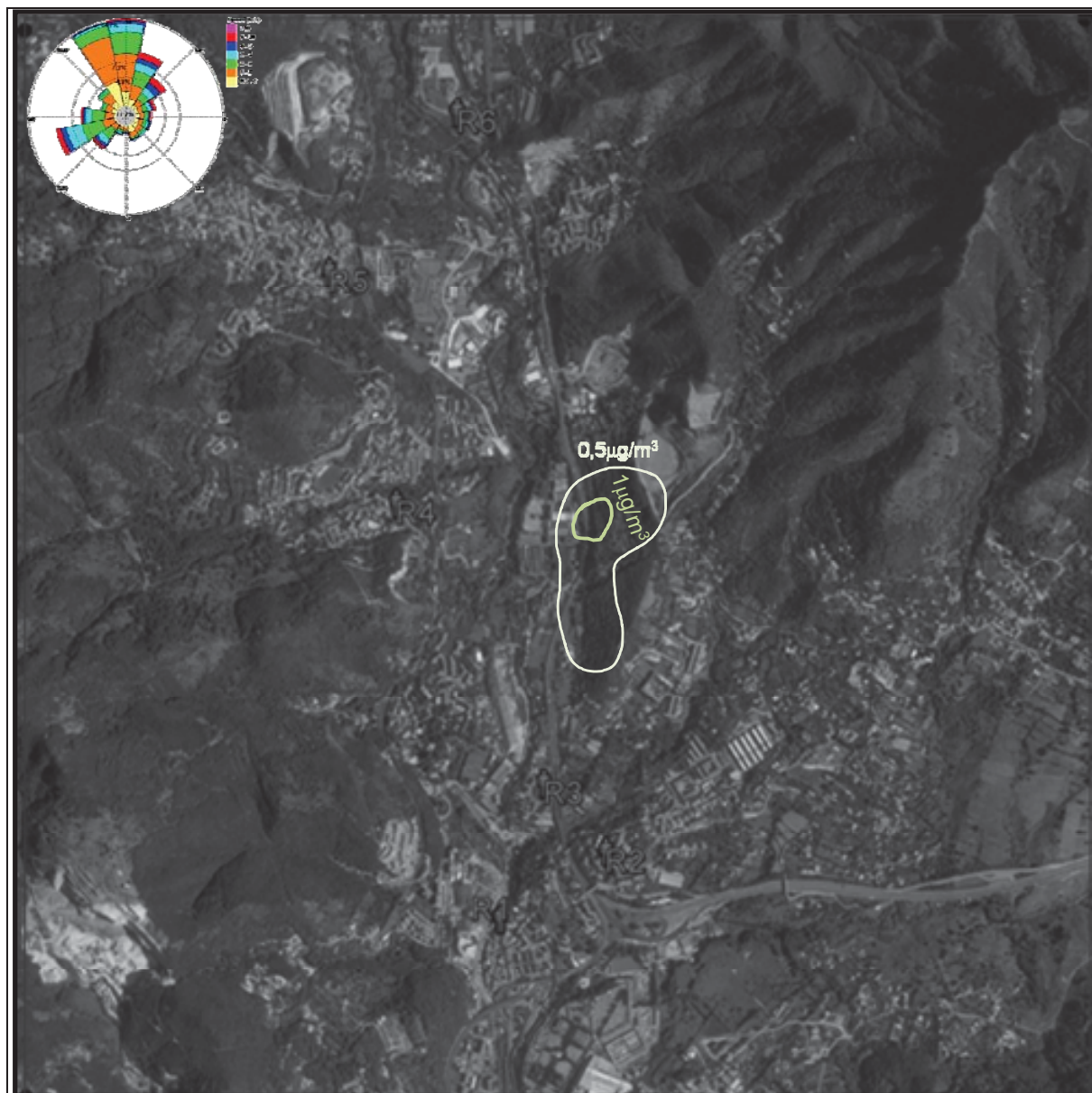
Figura 4.14 – mappa della concentrazione media annua al suolo di PTS in riferimento allo scenario di esercizio ordinario delle Fonderie Pisano.
