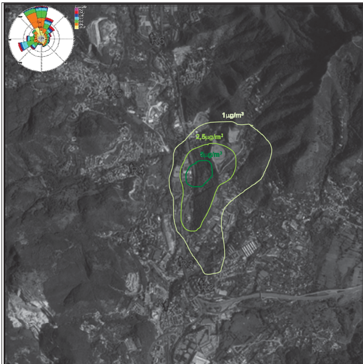
Figura 4.16 – mappa della concentrazione media annua al suolo di PTS in riferimento allo scenario massimamente emissivo delle Fonderie Pisano.
