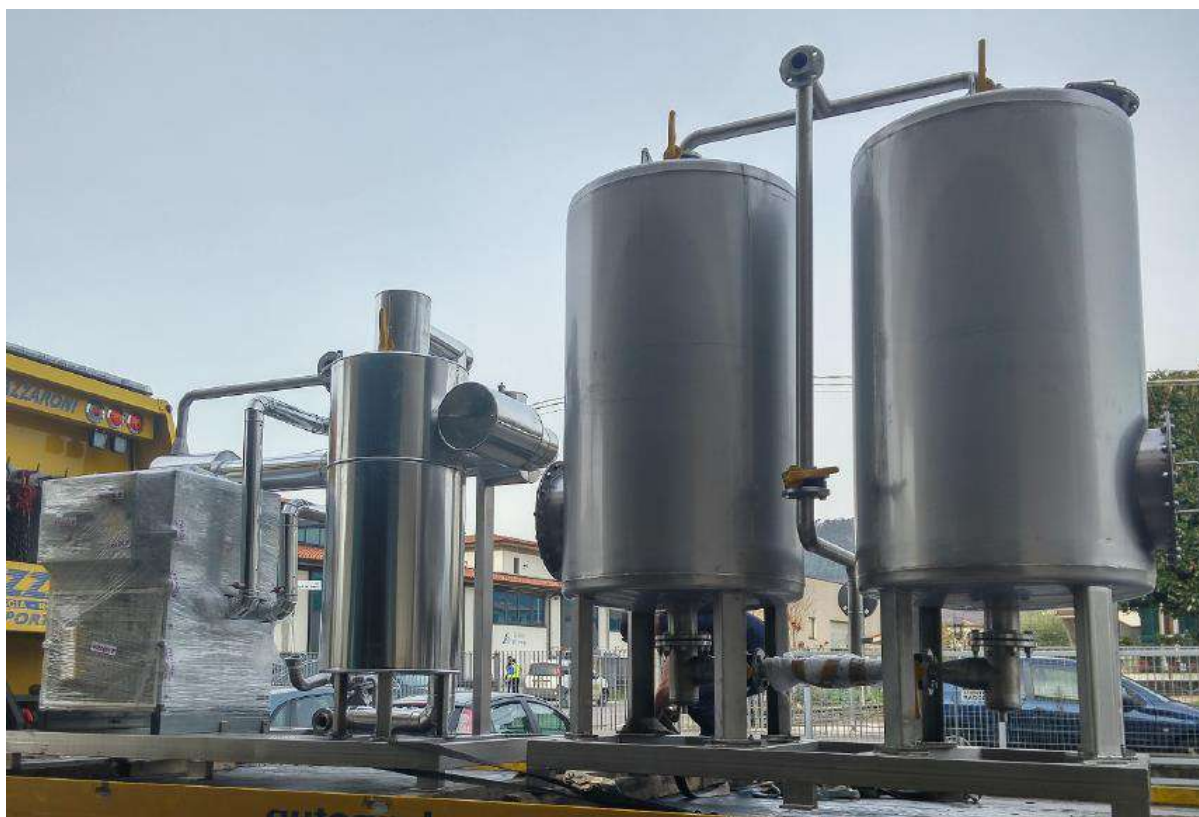
Figura 11 - Installazione tipica del sistema di Essiccazione e Filtrazione
