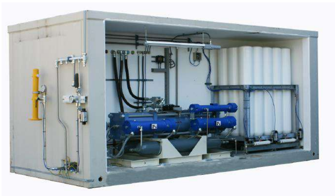
Figura 18 - Rappresentativo di un compressore alloggiato in cabinato in cemento armato
