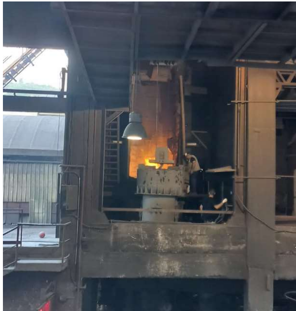
Fig.3 – apertura bocca di carico del forno “cubilotto”
