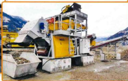
Macchina "Tornado" installato in un impianto esistente per trattamento inerti da costruzione e demolizione. Machinery "Tornado" installed in an existing plant for construction and demolition aggregates treatment.
