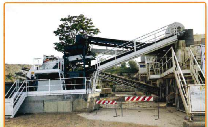
Macchina "Tornado" installato in un impianto esistente per trattamento inerti da costruzione e demolizione. Machinery "Tornado" installed in an existing plant for construction and demolition aggregates treatment.
