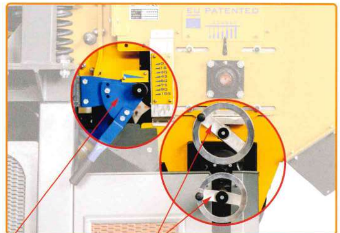
Sistema di regolazione diffusore. Diffuser adjustment system.
