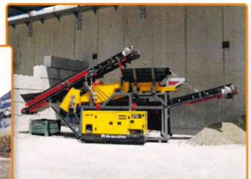
Gruppo Tornado nella configurazione su skid. Tornado Group in the skid configuration.
